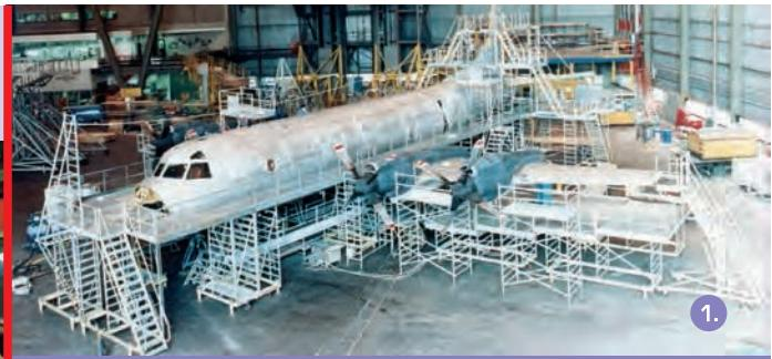
1. Flugzeugdock [Systembauteile] / Aeroplane dock [System components] / Dispositif d'accostage pour avions [Composants modulaires]
