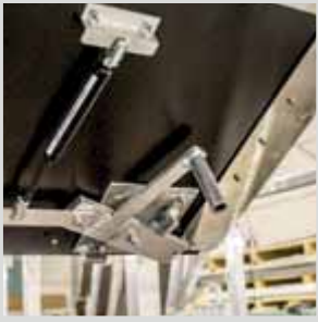
Klapp-Mechanismus des großen Belags der oberen Ebene
