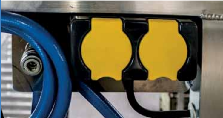
Steckdosen direkt auf der Arbeitsplattform Electric sockets directly on the working platform
