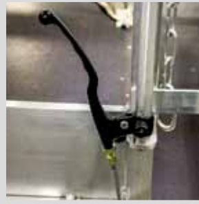
Hebel zum Lösen der Bremse an den Totmann-Bremsrollen
