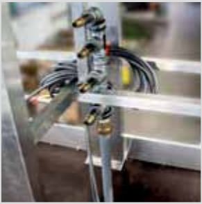
Druckluftanschlüsse auf der Plattform Compressed air connections on the platform
