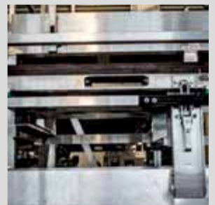
Ausziehbares Podest mit Rastbolzen
