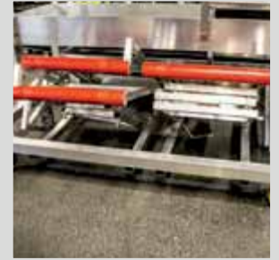
Parkpositionen für die abnehmbaren Geländer unter der Bühne
