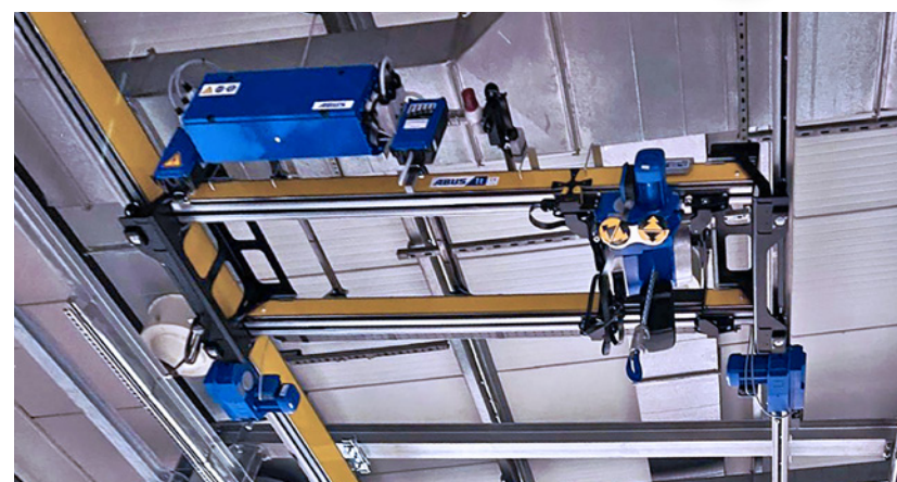
Kranbedienung über eine Funkfernbedienung oder Handtaster
