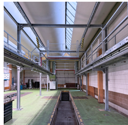
Bühnenbreite: ausgefahrene Plattform 2426 mm, eingefahren 3326 mm
