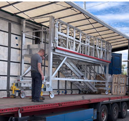
Transporthöhe der ganz nach unten gefahrenen Bühne 2915 mm, optimal für den Transport via Spedition 5040 Breite
