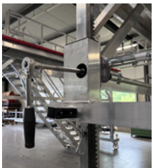
Manuelle Höhenverstellung mit Akkuschrauber oder Handratsche
