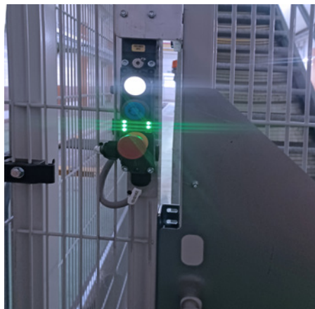
Sicherheit an oberster Stelle: Selbstschließende Zugangstür: Elektromechanisch verriegelt mit Panikfunktion
