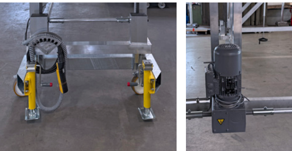
Lagesicherung Spindel und Parkmöglichkeit für Steuerelement elektrischer Höhenverstellung mit Motor (rechts)
