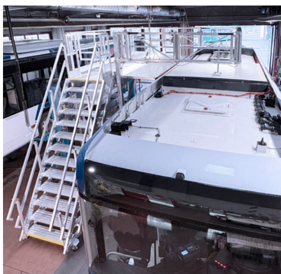
Mobiler Dacharbeitsstand mit ausgeklapptem Schutzgeländer
