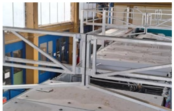
Variable Absturzsicherung einzeln oder mit zweiter Bühne gekoppelt (s. Abb.) // Variable guardrail individually or coupled with second platform (see illustration)
