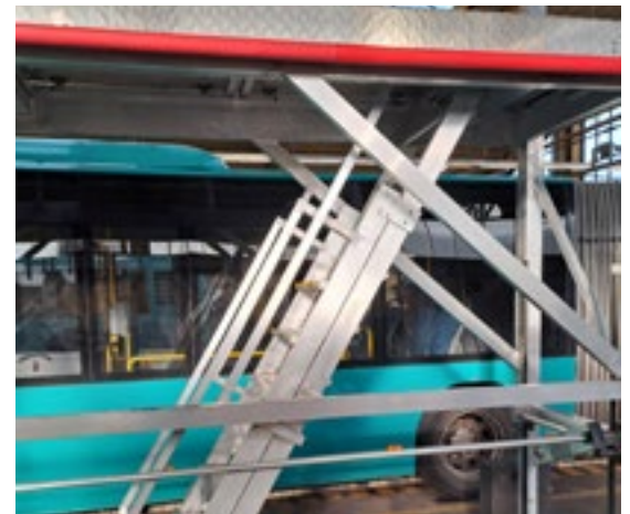
Aufstiegstreppe platzsparend innen // Access steps, space-saving inside
