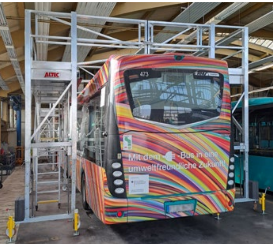
Spaltmaß „0“ an den Fahrzeugseiten // Gap dimension „0“ on the vehicle sides
