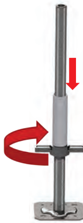
Einstecken der Fußplatten
